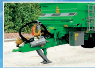
Гидравлическая подвеска осей и дышла
