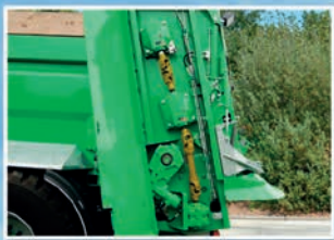
Привод от редукторов и кардана
