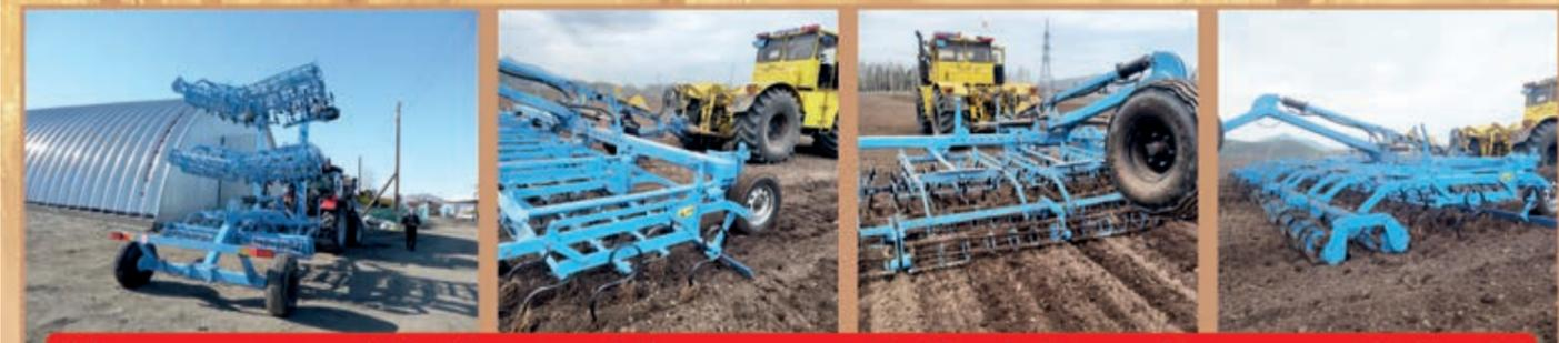
Ширина захвата: от 6 до 12 метров, Рабочая скорость: до 12 км/ч, Производительность: до 14 га/ч.
