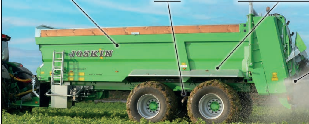
Установка широких колёс под кузовом без превышения разрешенной регламентом ширины
