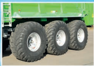
Установка широких колёс под кузовом без превышения разрешенной регламентом ширины
