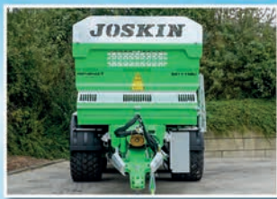
Монолитный кузов из стали ВПТ
