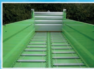
Планочно-цепной транспортер с легко доступным натяжным устройством
