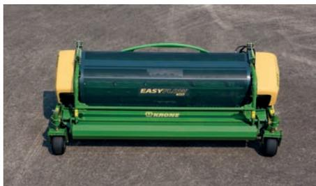
Циркулирующий коллектор состоит из двойных и одинарных захватывающих пальцев, а также двойных и одинарных ножей резания. Все изнашивающиеся детали могут быть заменены по отдельности. В зоне погружения коллектора устанавливаются двойные
