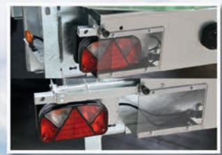
Встроенные и откидные фары, защищенные экраном из плексигласа в закрытом положении
