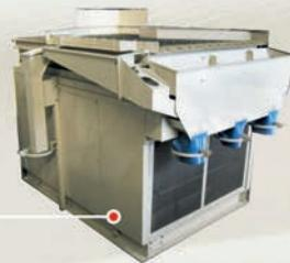
Пневмосортировочные столы Клен-ПС производительностью 5-8 т/ч
