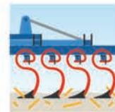
**Пружинные зубья** равномерно распределяют растительные остатки по поверхности поля.
