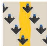
**Сплошное перекрытие** даже с учетом изнашивания стрельчатых лап в процессе работы, благодаря расположению рабочих органов в 4 ряда и ширине каждой лапы в 215 мм. Это также **исключает забивание** культиватора растительными и пожнивными остатками.
