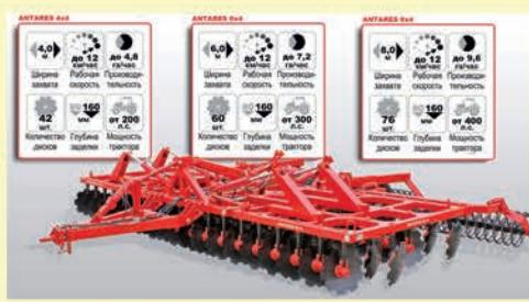
ANTARES – дисковая модульная прицепная предназначена для ресурсосберегающей предпосевной обработки почвы под посев зерновых, технических и кормовых культур, уничтожения сорняков и измельчения пожнивных остатков после уборки посевых культур, а также измельчения, выравнивания и уплотнения почвы после дискования.
