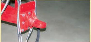
Регулировка перестановки прицепного устройства позволяет агрегатировать с тракторами отечественного и импортного производства
