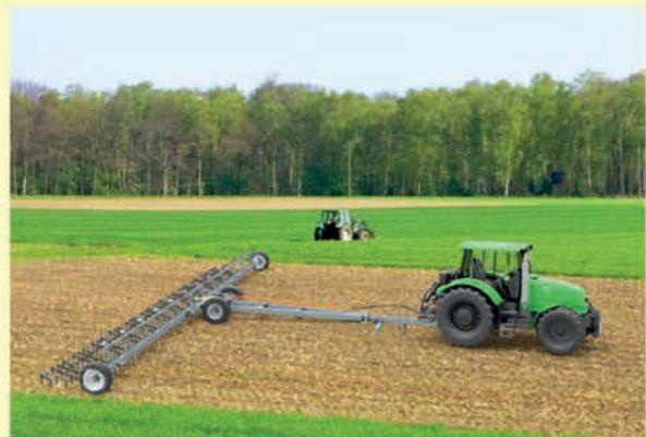
БГЗ предназначена для выравнивания поверхности поля, ранневесеннего боронования зяби, боронования озимых, предпосевной провокации, а также заделки в почву удобрений. Рыхлит поверхность почвы на глубину до 120 мм, в зависимости от плотности почвы и угла атаки зубьев, тем самым тщательно размельчая и уничтожая всходы сорняков, стерни, солому и растительные остатки. Осуществляет довсходовое или послевсходовое боронование технических и зерновых культур.
