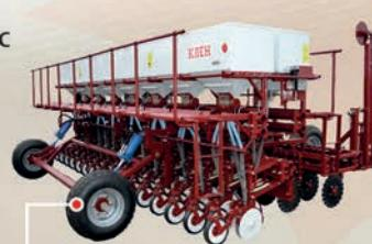
Зернотравяные сеялки с шириной захвата 1,5-6 м
