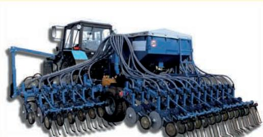
Сеялки «Быстрица» являются высокопроизводительными устройствами, предназначенными для посева зерновых, бобовых, крестоцветных, клевера, тимофеевки, люцерны и прочих семян с одновременным внесением гранулированных минеральных удобрений.
