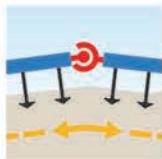
**Хорошо копирует поверхность поля.** При ширине захвата в 11 метров рама культиватора выполнена из 5 секций, соединенных между собой шарнирно.
