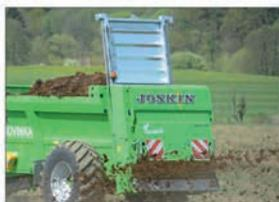
• Усиленная дверь для точного разбрасывания т/га
