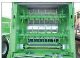
• Тарелочный механизм с горизонтальными валами
