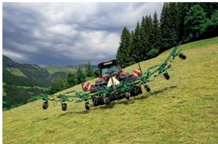
траекторией движения навески борошителя, где Krone также предпочитает V-образный дизайн с четырьмя позициями для центрального винта. Для работы с передним опорным колесом навеска оснащена продольным отверстием. Маятниковая навеска, включая подвижные нижние цапфы, обеспечивают наилучшее копирование почвы в работе, кроме того, точки крепления верхнего и нижних рычагов дают возможность безопасно передвигаться по дороге при транспортировке даже на маленьких тракторах.
