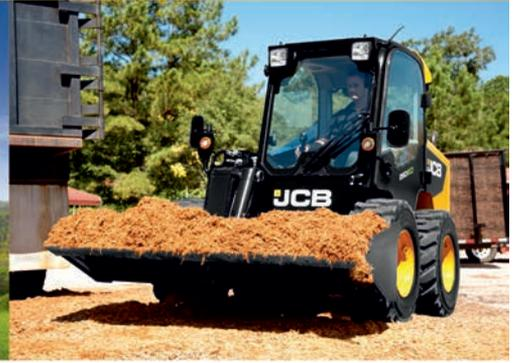
Мини-погрузчики JCB 155 с бортовым поворотом и вертикальным подъемом – компактные и маневренные, созданные специально для работы на небольших площадках (номинальная рабочая грузоподъемность – 703 кг), оборудованы уникальной однобалочной стрелой и боковым входом.
