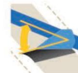
**Изменяемая ширина захвата корпуса.** Ступенчато меняется поворотом державки корпуса (30-35-40 см)
