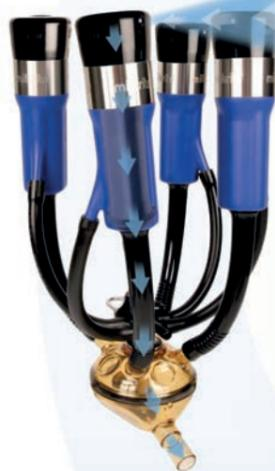
Вход воздуха в систему через отверстие в головной части сосковой резины снижает вредное воздействие вакуума и гарантирует:
