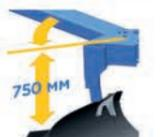
**Исключено забивание пожнивными остатками** за счет увеличенного расстояния от нижней плоскости корпусов до рамы (750 мм).
