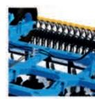
**Комплектуется катками в зависимости от типа почвы:** спиралевидными, комбинированными, зубчатыми
