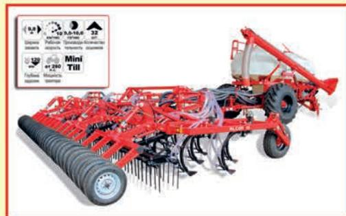
Предназначены для полосового посева зерновых, зернобобовых и других культур по минимальной и традиционной технологии обработки почвы. Посевные комплексы ALCOR 7,5 и ALCOR 10 комплектуются пластиковыми бункерами модели 9000 общим объемом 9 630 л [5215 л + 4415 л].
