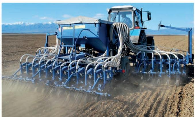
Сеялка агрегатируется с тракторами МТЗ-82 и др.
