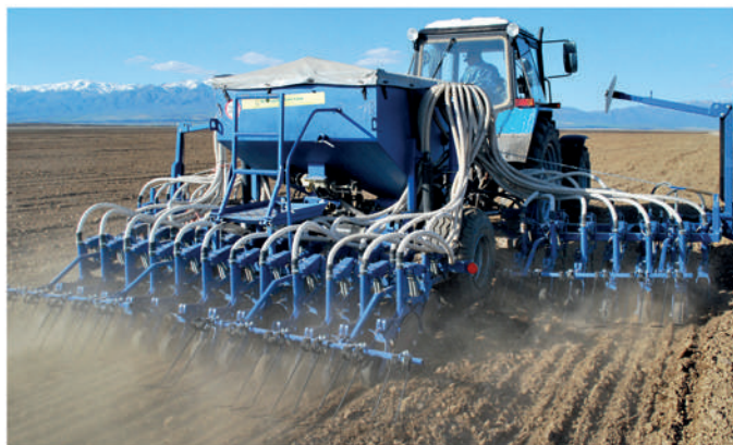
Сеялка агрегируется с тракторами МТЗ-82 и др. Два вида рабочих органов - двухдисковый сошник и анкерный сошник
