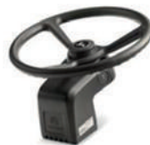
AutoTrac Controller интегрированная система гидравлического рулевого управления
