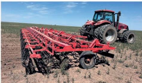
Предпосевной культиватор TURBOCOMBINATOR
