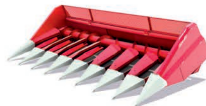
ЖАТКА ДЛЯ УБОРКИ ПОДСОЛНЕЧНИКА FALCON 470/670/870/1270 4/6/8/12 рядков производительность до 9,7 т/ч
