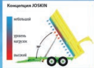
Телескопический цилиндр расположен ближе к трактору
