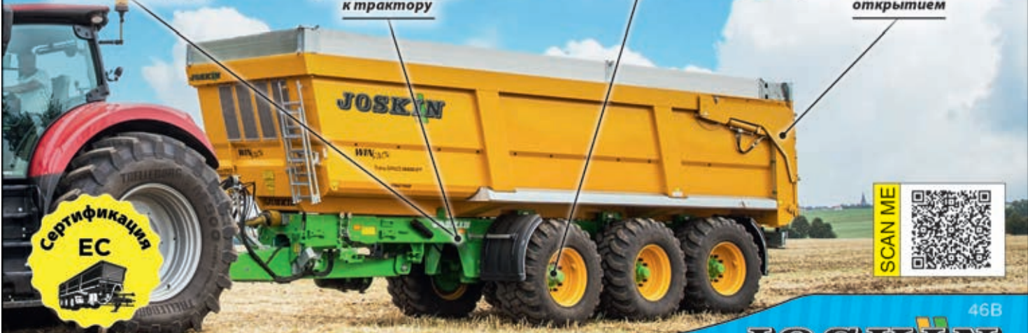
Гидроцилиндр опрокидывания на двойном шарнире
