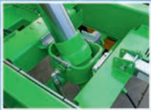
Гидроцилиндр опрокидывания на двойном шарнире
