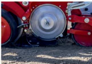
Высокая точность закладки семян при высокой скорости сева благодаря низкому расположению высевающего аппарата (незначительная высота падения посевного материала)
