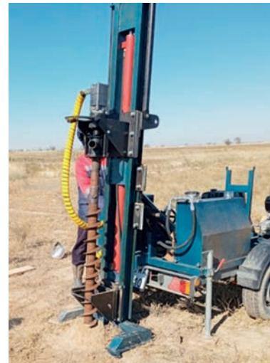
В ходе испытаний определены оптимальные расстояния между шурфами в зависимости от видов почв, объем раствора дезинфектанта, необходимый для заполнения скважин и полного увлажнения грунта захоронения на всю глубину.
