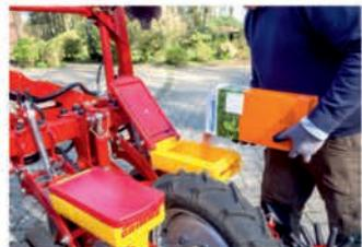
Посев до 18 га, не выходя из кабины, бункер для семян емкостью на 1,5 посевную единицу
