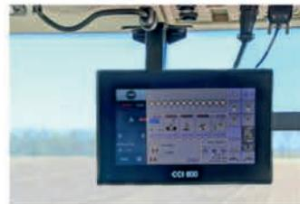
Пульт управления ISOBUS CCI 800 с цветным дисплеем, сенсорным управлением и световым сенсором, предотвращающим ослепление при работе в любое время суток
