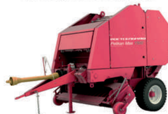
Пресс-подборщик рулонный PELIKAN MAX 1500 ширина захвата 2 м производительность до 12 т/ч
