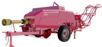
Пресс-подборщик тюковый TUKAN 1600 ширина захвата 1,6 м производительность до 10 т/ч
