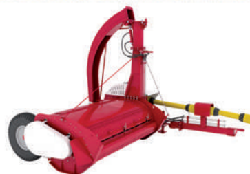
Комбайн прицепной кормоуборочный STERN 2000 ширина захвата 2 м производительность 38 т/ч
