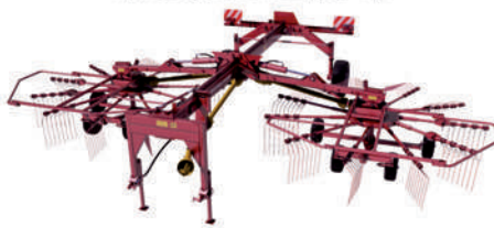
Грабли 2-роторные прицепные KOLIBRI DUO 810 ширина захвата 6,9–7,7 м производительность до 8 га/ч
