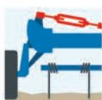
**Наличие 4 талрепов** позволяет одному человеку без привлечения подъёмных устройств быстро и точно выставить нужную величину заглубления зубьев.
