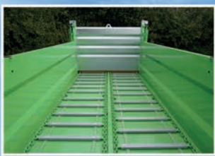
Двойной транспортер с планками на болтах и цепью категории 80
