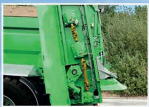
Привод от редукторов и кардана
