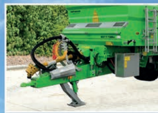
Гидравлическая подвеска осей и дышла
