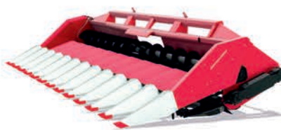
ЖАТКА ДЛЯ УБОРКИ КУКУРУЗЫ CORN STREAM 6/8/12 рядков производительность 40 т/ч
