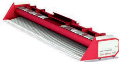
ЖАТКА ДЛЯ УБОРКИ ПОДСОЛНЕЧНИКА SUN STREAM ширина захвата до 12 м производительность до 8,3 т/ч
