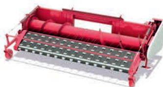
ПЛАТФОРМА-ПОДБОРЩИК SWA PICK ширина захвата 3,4 и 4,3 м система копирования рельефа
