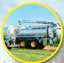
Верхняя стрела для простого заполнения цистерны при помощи воронки на транспортной цистерне
