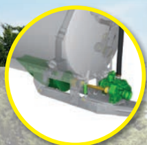
Насос Vacu-Storm: вакуум + центробежный насосы = гарантия высокого расхода
