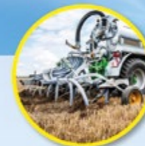
TERRAFLEX/2 Ширина захвата: от 2,7 до 5,2 м
