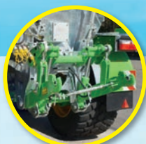
Встроенный подъёмник и гидравлическое оборудование „AUTOMATE 2+4“
