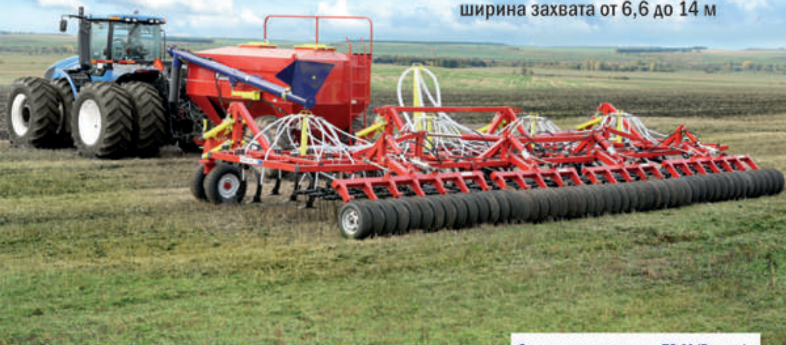
Сеялки точного высева ТС-М (Россия) 8-ми и 12-тирядные. Междурядье 45 и 70 см
