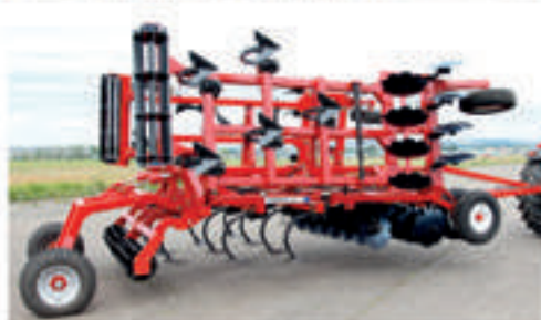
Дискатор 2-х, 4-хрядный ширина захвата от 3,2 до 9 м
