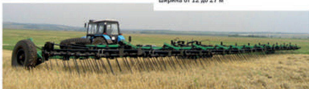
Тяжелые стерневые бороны КАМА ширина от 12 до 27 м
