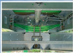
V-образное дышло с параболическими рессорами
