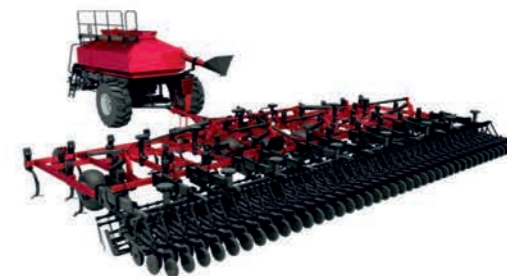
Посевные комплексы серия SH/SC рабочая ширина захвата до 18,3 м глубина обработки от 5 до 15 см
