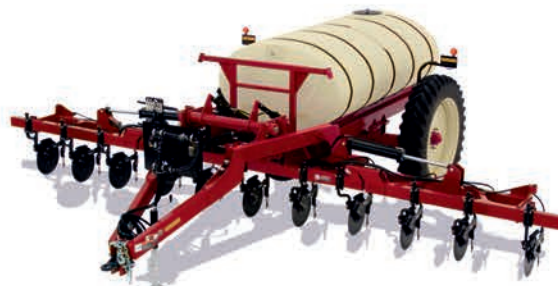
Аппликаторы-растениепитатели жидкими удобрениями RSM AF-3800 рабочая ширина захвата 8,4 м объем основного бака 3800 л
