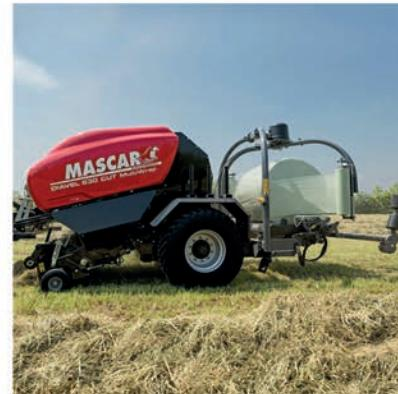
Фиксированная вальцовочная камера в комбинации с обмотчиком
