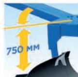
**Исключено забивание пожнивными остатками.** Высокая стойка, корпуса вынесены из-под рамы вправо.
