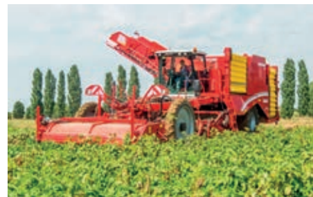
VARITRON 470 PlatinumTERRATRAC с почвосберегающей гусеничной ходовой частью.
