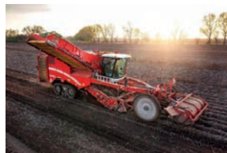
Четырехрядный самоходный уборочный комбайн VARITRON 470 с бункером непрерывного режима работы NonstopBunker объемом 7 тонн.
