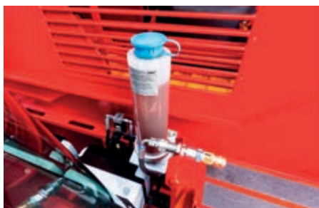
Больше комфорта для пользователя благодаря серийной смазочной системе для цепи бункера.
